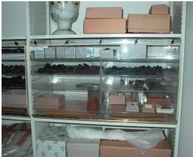
Klimakasse reguleret med silica-gel til bevaring af arkæologiske jerngenstande
